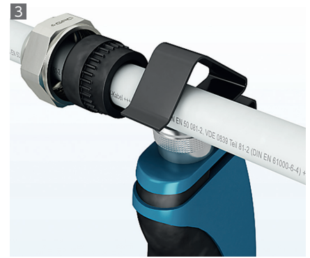
3 シールドケーブルの被覆を剥く。
